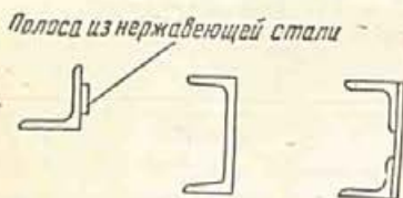
Фиг. 134. Закладные части под боковые уплотнения.
