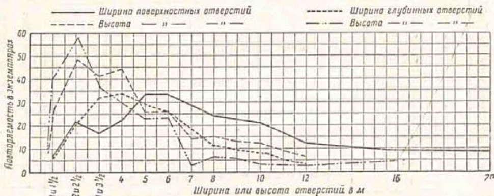
Фиг. 4. Повторяемость размеров отверстий, перекрытых плоскими поверхностными и глубинными затворами.
